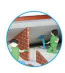
L'applicazione nel sottotetto permette di isolare in modo veloce ed efficace solai non calpestabili oppure difficilmente accessibili perchè costituiti ad esempio da muricci chiusi o a nido d'ape; in caso di solette irregolari con l'insufflaggio si può garantire la planarità dello
